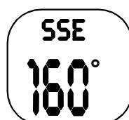
Oprima el botón **BEARING**. En seguida cambian los dígitos indicadores de la dirección según sea la dirección de la brújula.
